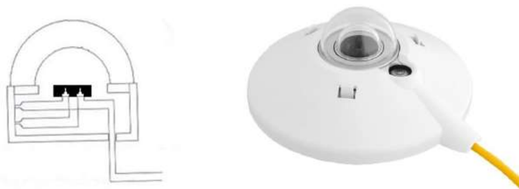
شکل ۱: دستگاه پیرانومتر جدید همراه با طرح مدار داخلی آن
