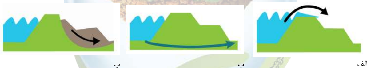
شکل ۲: مکانیزم‌های شکست سیل‌بند: الف) فرسایش خارجی ب) فرسایش داخلی پ) ناپایداری شیروانی [2].
