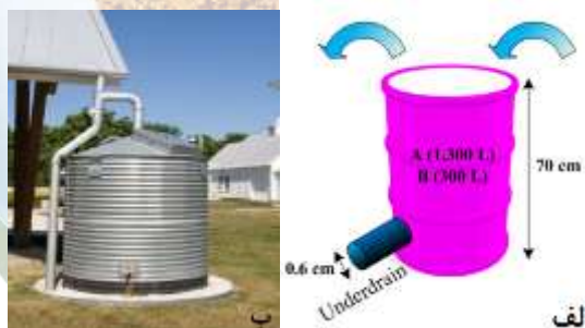
شکل ۱-الف: طرح شماتیک بشکه باران، ب: تصویر کار گذاشته شده [۲۳ و ۲۴]
