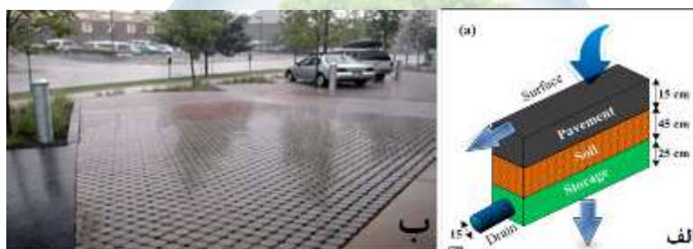
شکل ۵-الف: جزئیات اجرایی پیاده‌رو نفوذپذیر، ب: نمایی از پارکینگ با استفاده از کف‌پوش قابل نفوذ [۲۳ و ۲۹]
