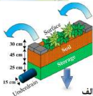
شکل ۸-الف: شماتیک اجرایی ترانشه نفوذ شکل، ب: اجرای ترانشه نفوذ [۲۳ و ۳۲]
