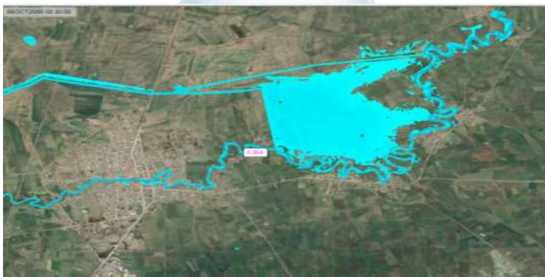
شکل ۱۱: پهنه سیل در حالت احداث کانال ۷۰ متری و کاهش دبی تا ۲۰۰ متر مکعب بر ثانیه
