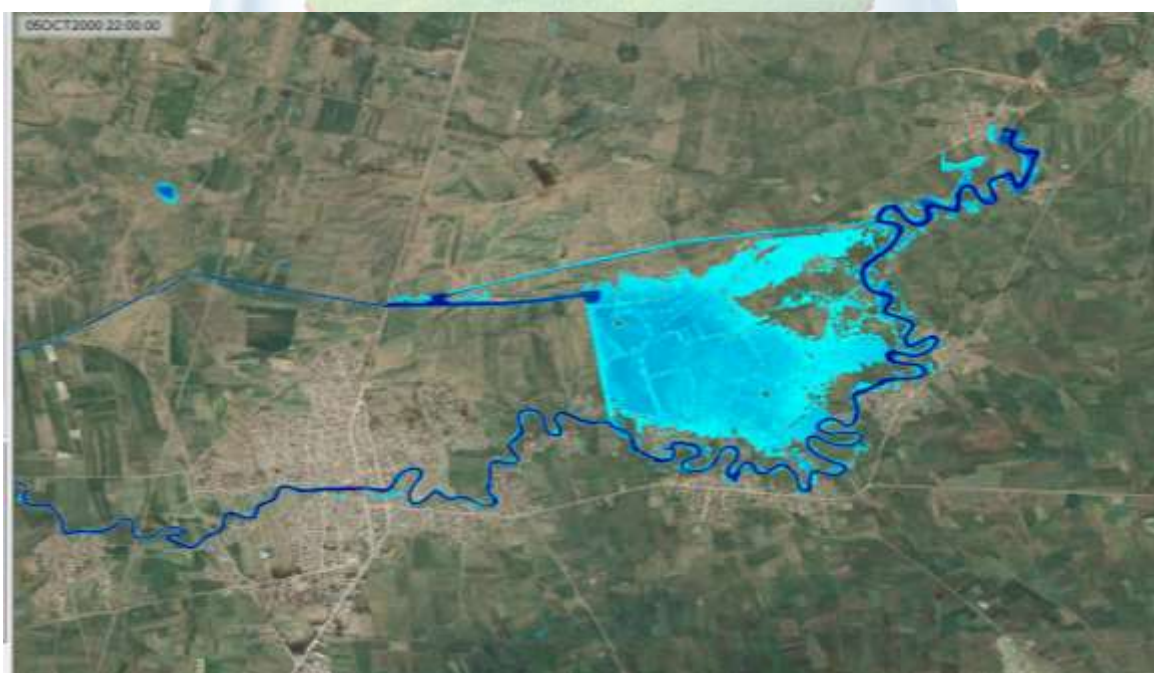
شکل ۱۳: پهنه سیل در حالت احداث کانال ۳۵ متری بتنی و کاهش دبی تا ۲۰۰ متر مکعب بر ثانیه
