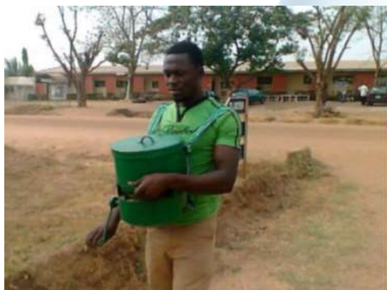
شکل ۷. بذرپاش قابل نصب بر روی سینه (۴)
