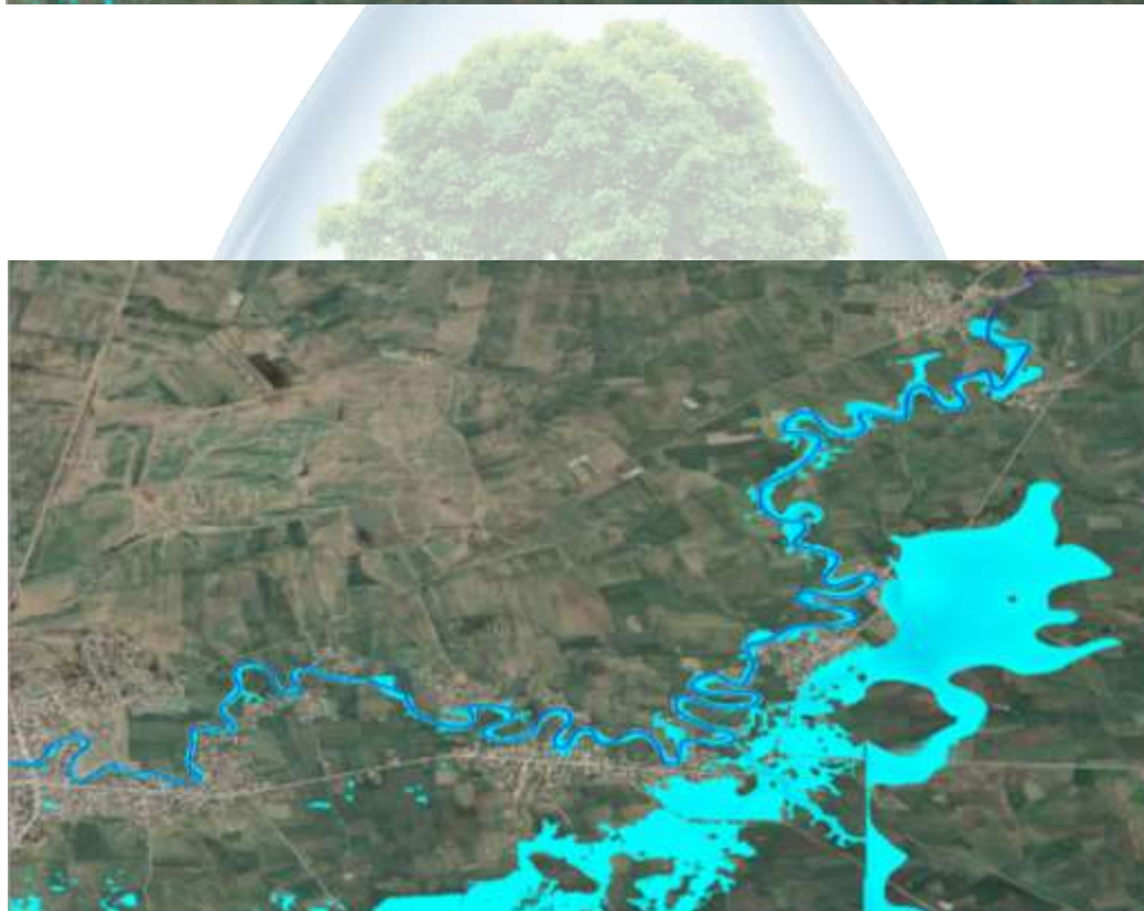
شکل ۴- چگونگی پخش سیلاب و سیل گیری در بالادست و محدوده شهر آق قلا
