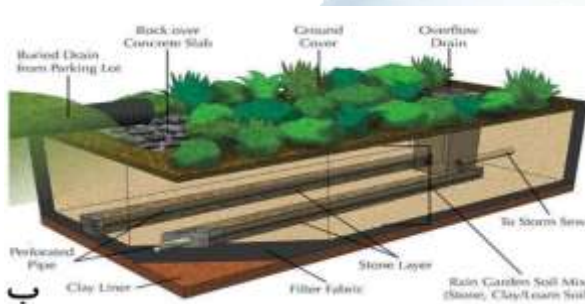
شکل ۷-الف: سیستم ماند بیولوژیکی، ب: جزئیات اجرایی سیستم ماند بیولوژیکی [۳۱]
