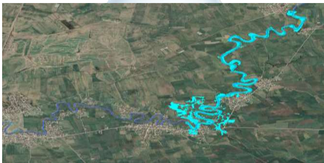
شکل ۸: شروع سیل‌گیری در صورت احداث دریچه یکطرفه در شاخه‌های ورودی گرگانرود
