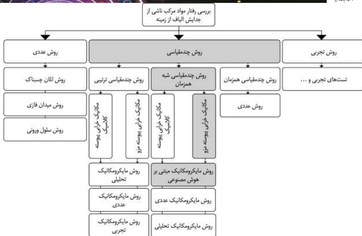
شکل ۱: مسیر بررسی‌های مختلف رفتار غیرخطی ناشی از جدایش الیاف از زمینه در مواد مرکب لایه‌ای
